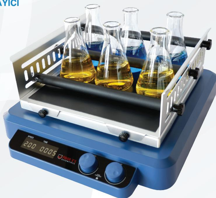
Çalkalayıcı cihazlar (shaker) gıda, ilaç, boyacı, Tekstil sanayilerinin kalite kontrol ve araştırma laboratuvarlarında farklı şekil ve hacimde cam kaplar içindeki sıvıların homojen olarak çalkalama işlemlerinde kullanılır. Cihaz kolay okuma için LED ekrana sahiptir. Çalkalama sırasında oluşabilecek sarsıntıları destekleyen koruyucu sallama modu mevcuttur. Şık ve kullanışlı tasarıma sahiptir. Mikroişlemciye sahip olduğu için dengeli çalışma sağlayarak numunenin zarar görmesini engeller.
